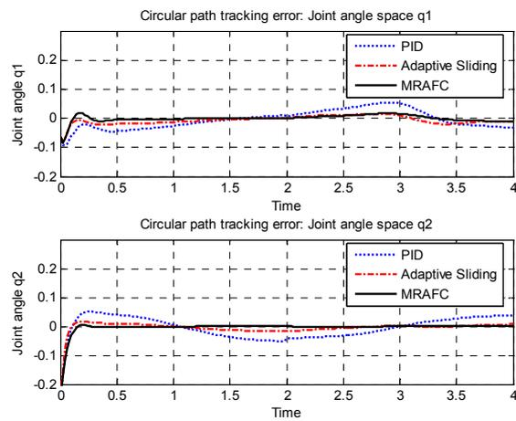
(d) Circular path-Joint space tracking error.
