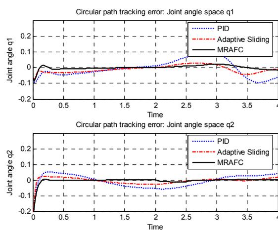
(d) Circular path-Joint space tracking error.
